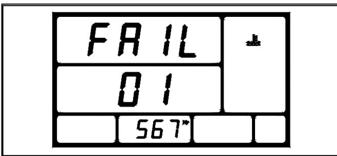
其中【FAIL】與 (01) 代表故障事件項次，【567Hr】代表發生故障時機組之運轉小時數，高水溫故障圖示代表本次之故障類別。
